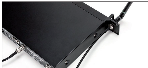
Für die frontseitige Montage der Antennen liegen Verlängerungskabel bei
