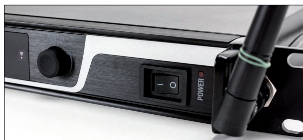
Ein vertiefter Ein/Aus-Schalter schützt vor versehentlichem Betätigen
