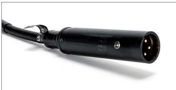
Ein solider XLR-Stecker dient zum Anschluss des Mikrofons
