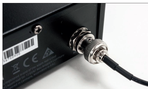
Für die Rack-Montage kann das Antennen-Verlängerungskabel angeschlossen werden
