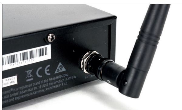
Die herkömmliche Montage der Antenne geschieht auf der Rückseite des Senders
