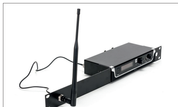
... so dass die Antenne ungestört von vorn empfangen kann
