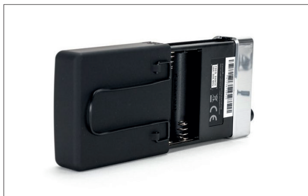
Das Batteriefach befindet sich rückseitig
