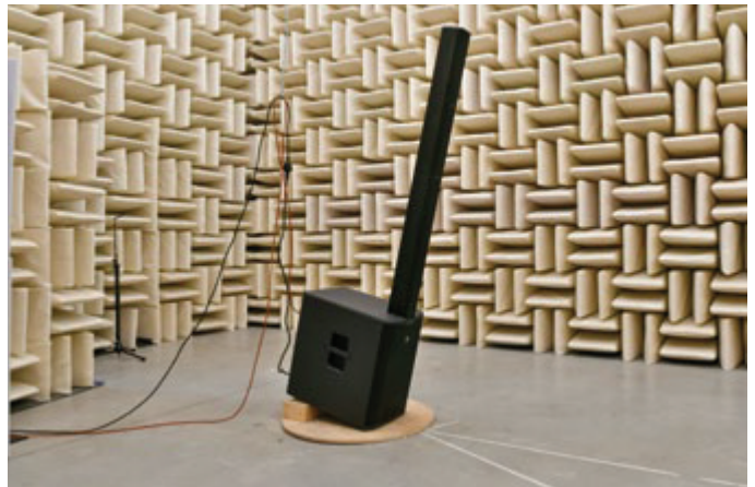
Mit der Neigung des MAUI 44 G2 für die Messung der horizontalen Directivity auf dem Drehteller zeigt die Mitte der Säule auf des Messmikrofon
