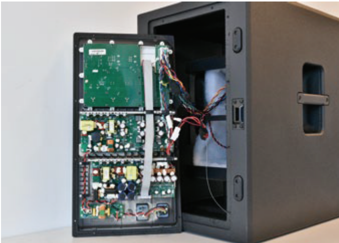
Das mächtige Elektronikmodul an der Rückwand des Subwoofers. Unten das Netzteil mit der Subwoofer-Endstufe, darüber die drei Endstufen für die Säule und oben die DSP Platine
