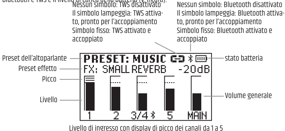
Livello di ingresso con display di picco dei canali da 1 a 5
