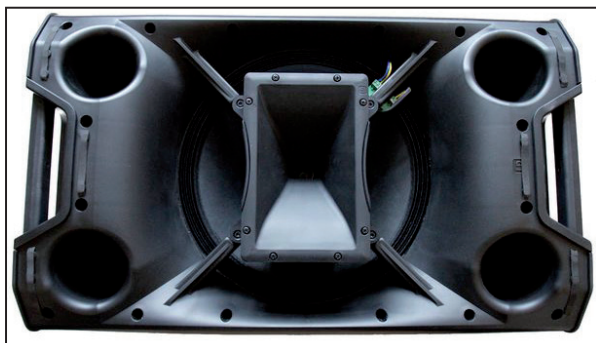
Die koaxiale Bauweise: Das Horn ist über dem Basstreiber montiert.
